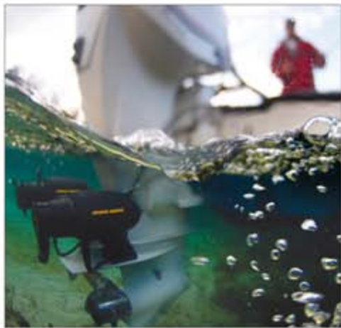
Montage des moteurs électriques Engine-Mount sur le moteur thermique
